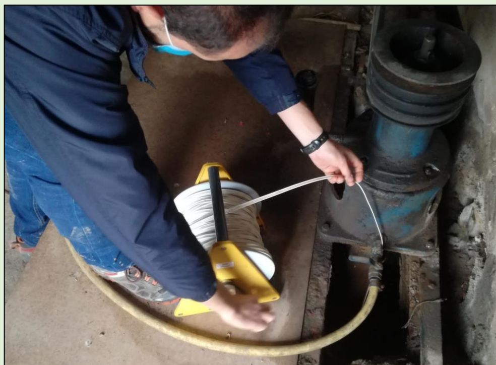
Fotografía de medición de los niveles piezométricos por los técnicos de campo de la CUAS Mancha Occidental I
